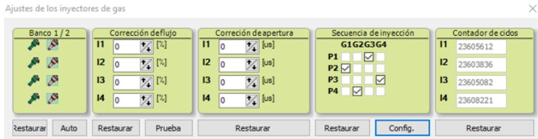
Figura 12 Configuración de los inyectores de gas
