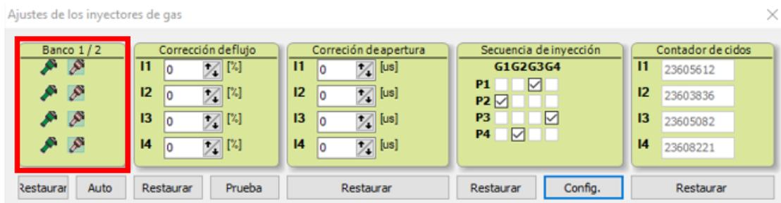
Figura 35 Asignación de los inyectores de gas al banco correspondiente
