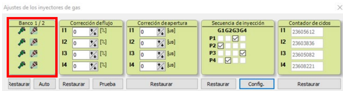
Figura 35 Asignación de los inyectores de gas al banco correspondiente
