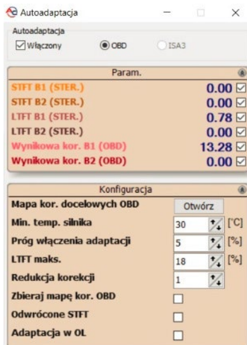
Rysunek 36 Konfiguracja adaptacji OBD.
