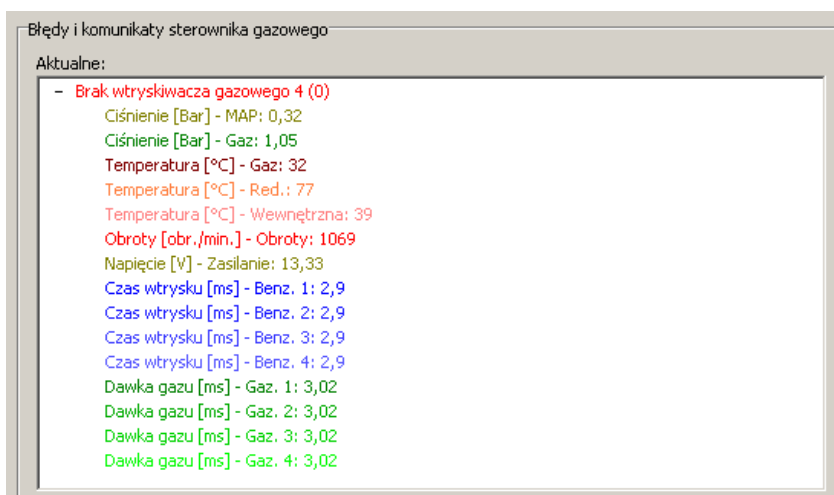
Rysunek 19 Ramka „zamrożona” błędu wtryskiwacza.
